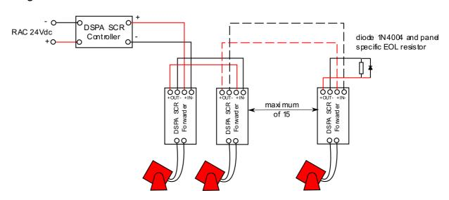
La resistencia EOL específica del panel debe estar de acuerdo con las especificaciones del panel utilizado.
