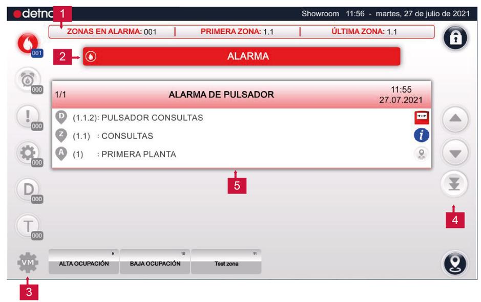
**1: BARRA DE ALARMAS** Se muestra si hay alguna alarma activa según la Norma EN54-2. Incluye un contador de zonas en alarma, La primera zona en alarma y la última zona en alarma.
