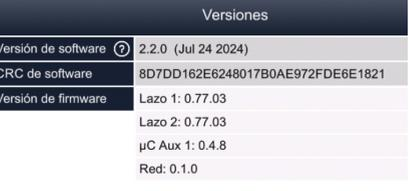
Versión de software de la central y versión del hardware de la central (tarjetas adicionales que estén conectadas a la central).
