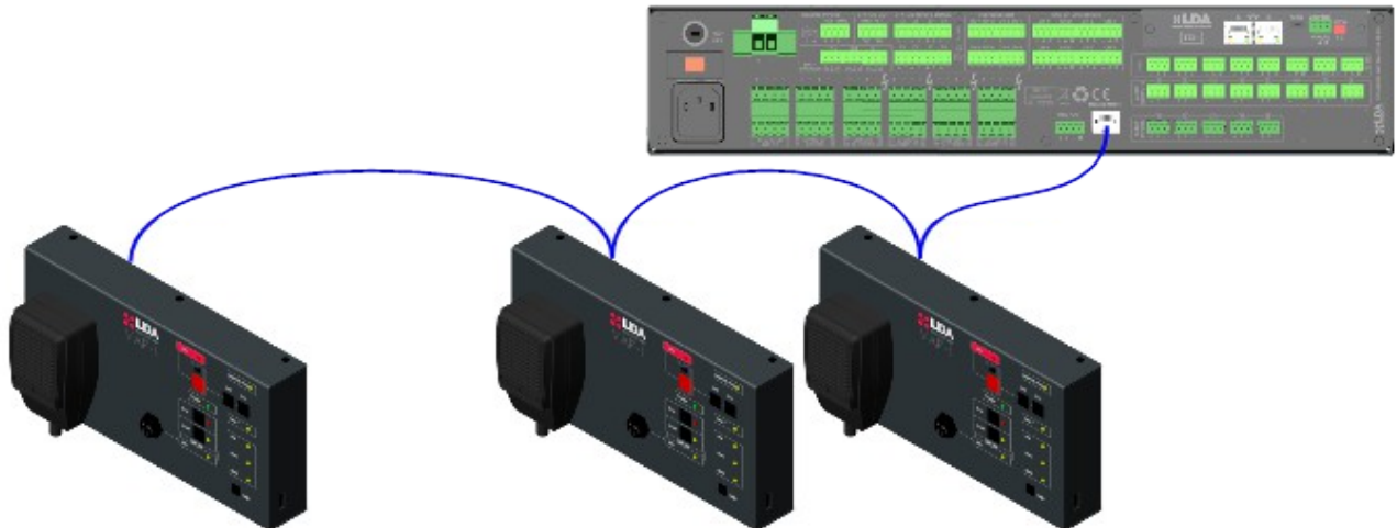
Ilustración 9: Conexión al Sistema de Evacuación por Voz
