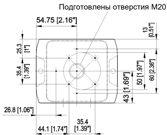
Схема расположения отверстий внутри корпуса (PA 1)
