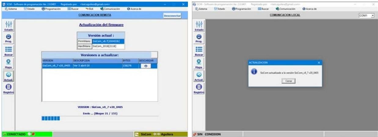
Se muestra una barra de progreso de la descarga, hasta mostrar una ventana indicando que el SisComFB2/CCD-100 se ha actualizado correctamente. El SisComFB2/CCD-100 se reinicia y se pierde la conexión.
