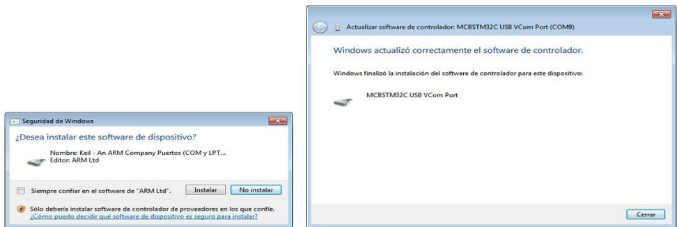
Se abre una nueva ventana, pulsar en “Instalar”, y posteriormente se mostrará una ventana de confirmación de instalación del driver, y el número de puerto COM (en este ejemplo el puerto COM9) que debemos utilizar.
