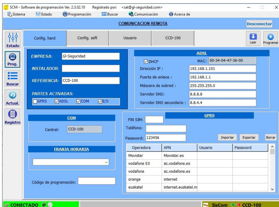
La programación de parámetros se divide en cuatro pestañas "Configuración hardware", "Configuración software", "Usuario" y "CCD-100".
