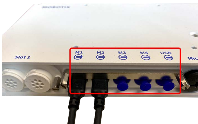
Fig. 4: 4 puertos de conexión de módulos y 1 interfaz USB-C
