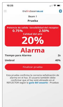
Pulse **Iniciar simulacro** para realizar un simulacro de incendio, el cual se efectúa ejecutando un algoritmo de prueba para reducir la potencia de salida, cosa que el receptor interpreta como un oscurecimiento. Cuando la señal recibida cae **por debajo** del punto del umbral, el detector activa el relé contra incendios (**el relé se activará una vez transcurrido el lapso previo a la detección de un incendio establecido, que puede situarse entre 2 y 30 segundos**).
