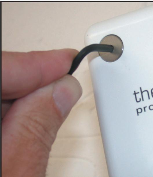
Atornille los tornillos del cabezal con la llave Allen de 3 mm suministrada.
