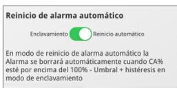
El detector viene configurado de fábrica para autorresetearse automáticamente cuando la señal recibida supera la histéresis del umbral de la alarma contraincendios. Se puede ajustar para que se cierre si su sistema lo requiere.
