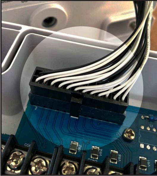
Conecte el cabezal a la placa básica enchufando primero el conector. Presione el conector hasta el tope para que el pestillo de pulgar sea eficaz.
