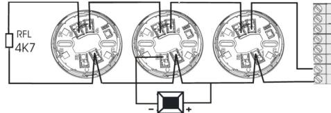
Nel caso dell'installazione di un ripetitore ottico è necessario rispettare la polarità dell'installazione come indicato nello schema.
