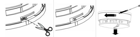
Se si desidera estrarre un rivelatore che è stato bloccato, si consiglia di utilizzare un cacciavite, premendo nella fessura del rivelatore e girando il rivelatore contemporaneamente in senso antiorario.
