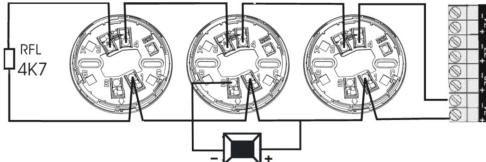
En cas d'installation d'un voyant d'activité, il s'avère indispensable de respecter la polarité du montage, comme indiqué sur le schéma précédent. La centrale utilisée dans l'installation doit être pourvue d'une limitation de courant de 100 mA.
