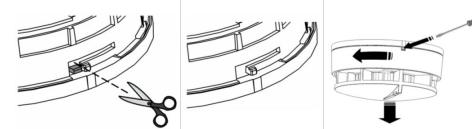
Pour retirer un détecteur qui a été verrouillé, il suffit d'exercer une pression sur la rainure de l'appareil à l'aide d'un tournevis, tout en tournant le détecteur dans le sens inverse des aiguilles d'une montre.
