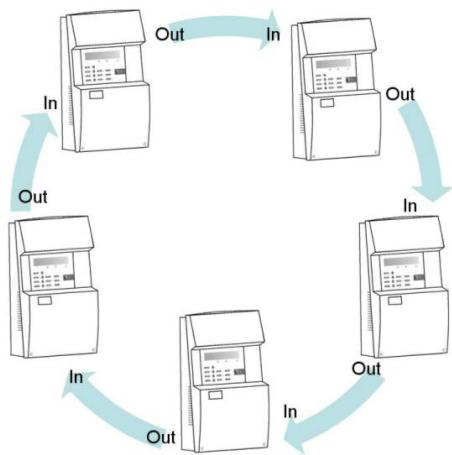
La tarjeta TMB-251-LT tiene dos puertos serie RS-485 para la conexión de entrada y salida de la red S-Network. Configure la posición del punto JP3 en modo de central analógica. Conecte los terminales de la regleta RS485 indicados con OUT (B, A y  $\pm$ ) a los terminales correspondientes de la regleta RS485 indicados con IN (B, A y  $\pm$ ) del siguiente equipo, bien sea una central u otro repetidor. Así sucesivamente hasta volver al repetidor.
